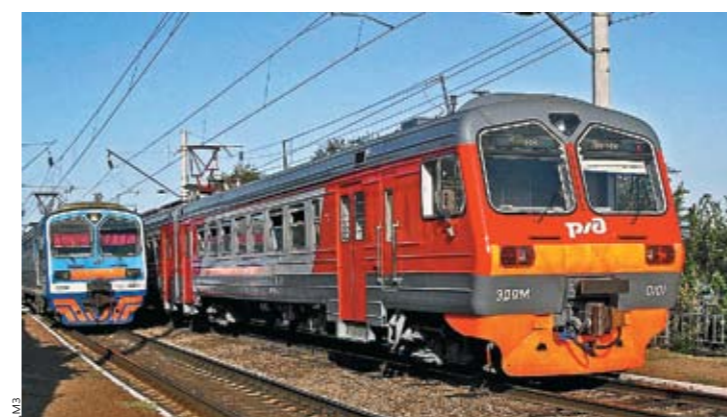
Электропоезд переменного тока ЭД9М
